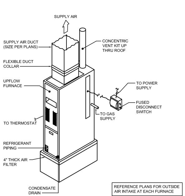
GAS FIRED UPFLOW FURNACE DETAIL N.T.S.
